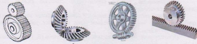
Рис. 1.2 Механические одноступенчатые передачи: а) зубчатая цилиндрическая передача; б) зубчатая коническая передача; в) червячная передача; г) зубчато-реечная передача
